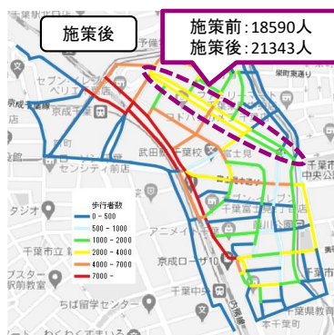
図 通行空間別歩行者交通量の試算結果（左：対策実施前、中・右：対策実施後）
