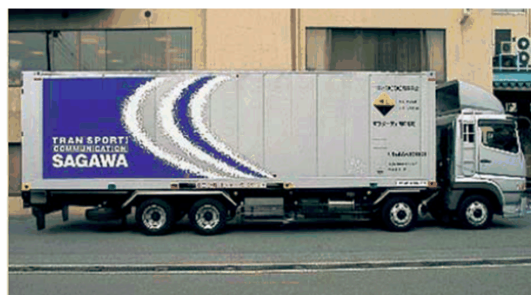
図 2-2-26 トラック輸送と鉄道輸送の双方で利用可能なコンテナの開発事例
