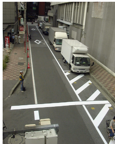
参考図 柏市における路上荷捌き駐車帯
